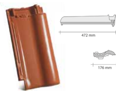
taška poloviční - hmotnost 1 ks cca: 2,5 kg - střední krycí šířka cca: 12,5 cm Poloviční taška není vhodná do úžlabí! Taška v zámku nenavazuje na základní tašku! Zámek má jiný tvar. Používá se jen jako jedna řada tašek od okapu do hřebene, pro dosažení rozšíření krycí šíře střešní krytiny o krycí šířku poloviční tašky, což je cca 125 mm.
